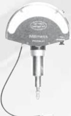
Прецизионный щуп Millimeter, сконструированный в 1937 году. Первый индикаторный прибор для измерения отклонения от заданных размеров с ценой деления 1/1000 мм
