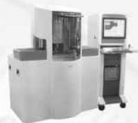
UNI VIS 250 – высокоточный оптический измерительный прибор с функцией обработки изображений для производственных измерений мельчайших геометрических характеристик в системах впрыска Common Rail
