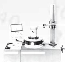
MMQ 2, компактный настольный прибор для контроля формы
