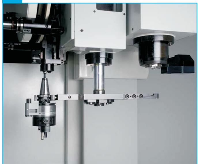
Расточные и торцовочные головки TA-CENTER созданы для работы на станках с автоматической сменой инструмента, а также на всех обрабатывающих центрах. Привод U-DRIVE управляет подачей салазок и положением инструмента во время вращения.
